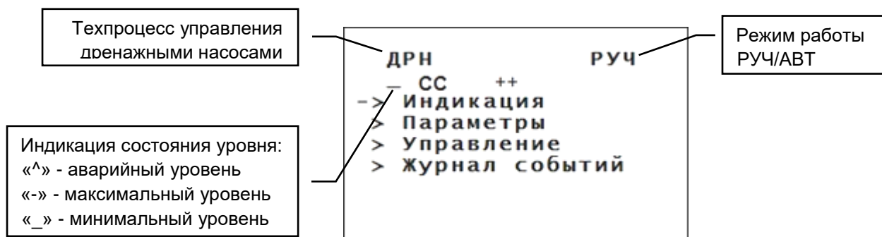
Рисунок 5.6 – Индикация техпроцесса управления дренажной системой
