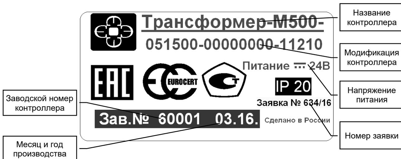
Рисунок 14.1 – Пример маркировки контроллера
