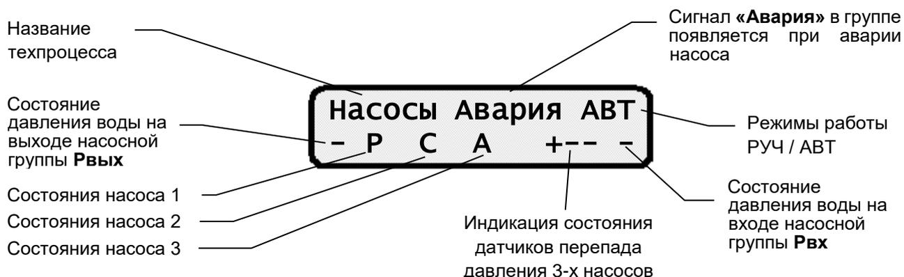
Рисунок 4.1 – Экран состояния техпроцесса «Насосы» с 3 насосами и 2 состояниями датчиков давления Рвых и Рвх
