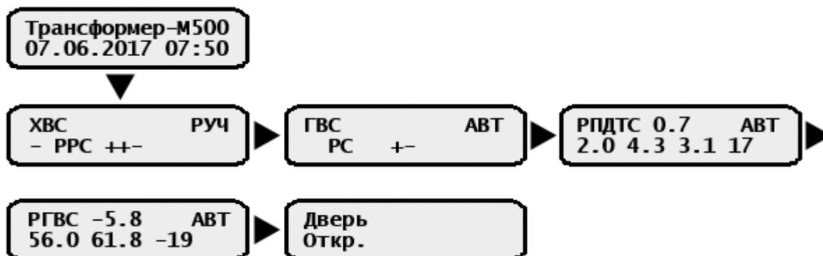
Рисунок 3.5 – Выбор техпроцесса на примере конфигурации «Водоснабжение»
