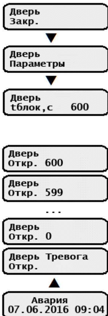
При входе на ЦТП дверь открывается и происходит срабатывание концевого контакта двери «открыта-закрыта». Если значение параметра «**Блокировка**» соответствует «**Вкл.**», то включается таймер, который отсчитывает время «**t блок**».
